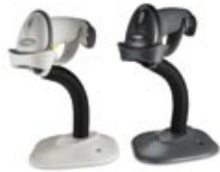
Запатентованные особенности конструкции сканера, а именно расположение электронной "начинки" на одной плате, а так же отсутствие подвижных частей в сканирующей головке, делают сканер максимально надежным и долговечным - на сканер дается 5 лет гарантии.
